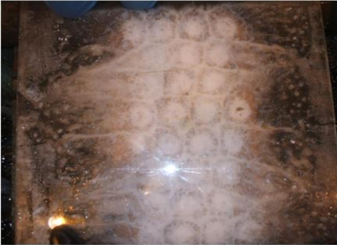
図 2. 29 下面の試験用ノズル噴射状況（上面）
