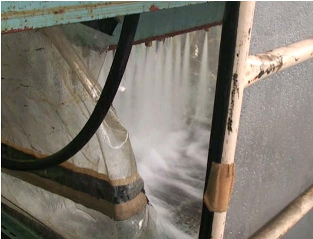
図 2. 30 上面の試験用ノズル噴射状況（側面）
