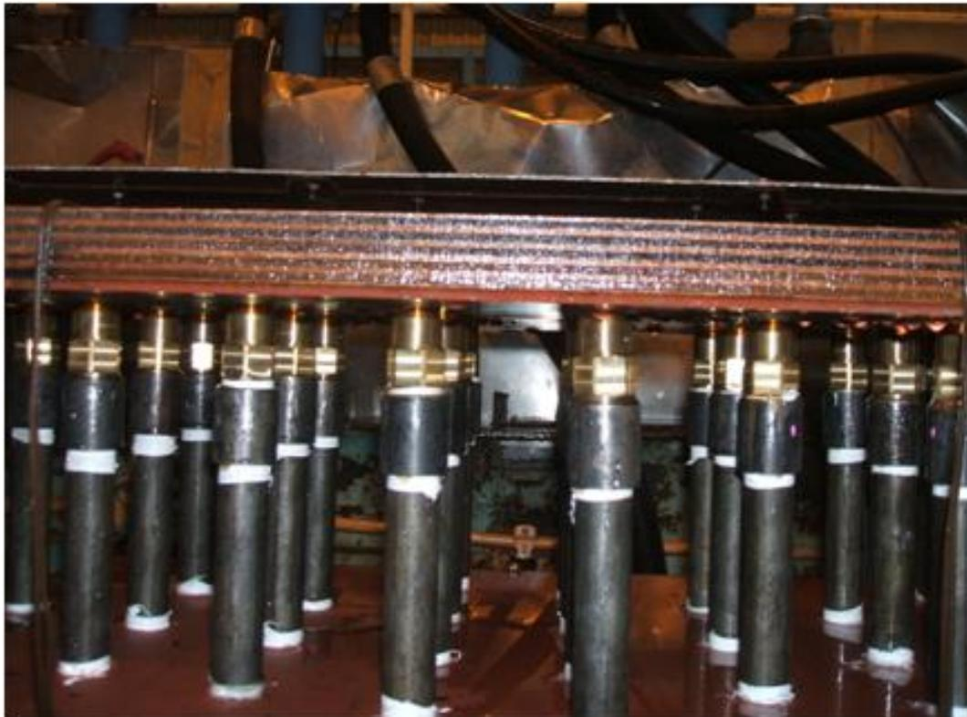
図 2. 28 下面の試験用ノズル設置状況（側面からみた様子）
