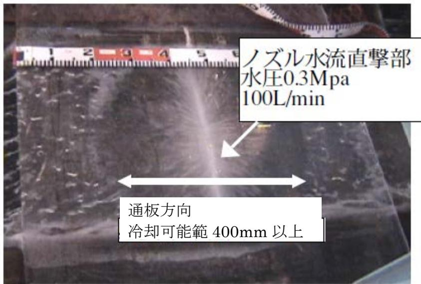
図2. 18 下面噴流衝突状況
