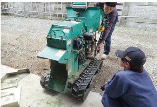
チップーシュレッダーの修理
