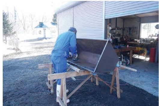
餌槽錆落とし
