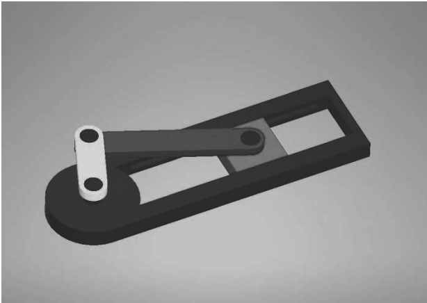
図3 練習課題例3：複数部品（部品点数：4）を[アセンブリ]の機能を使って組み立て
