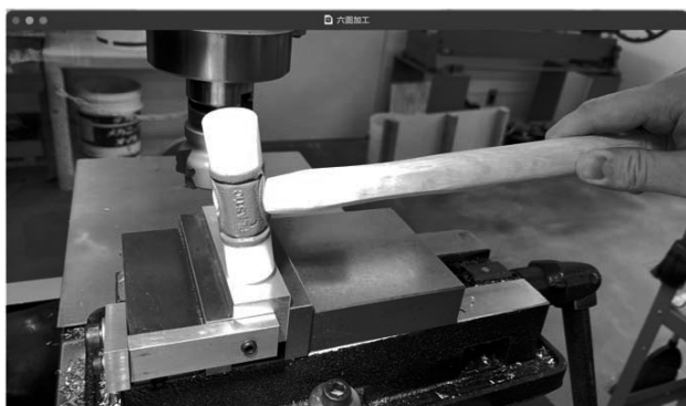
図 6. 六面加工の説明動画（段取りの場面）
