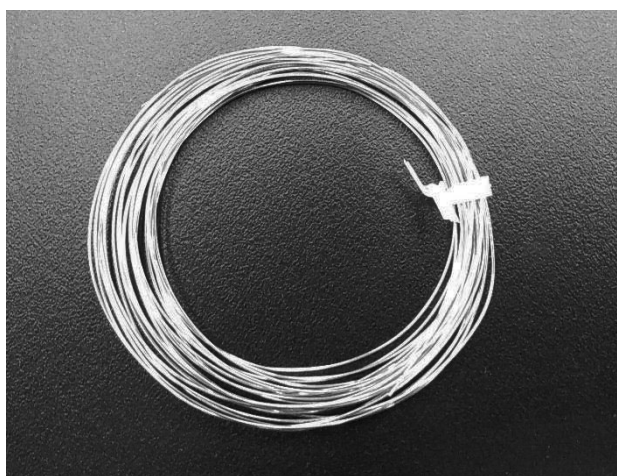
図1 購入したニクロム線（直径0.6mm）
