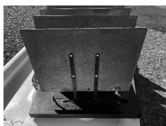
図1 マグネシウム電極の固定方法
