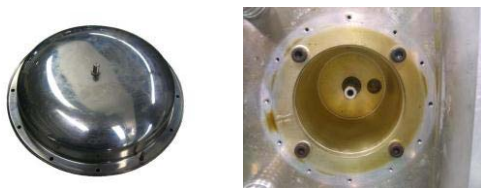
M4 ネジ下穴 鍋蓋と同時下穴加工
