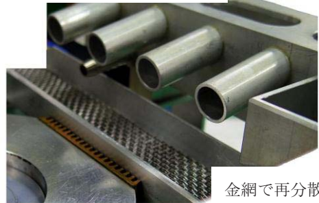
図 20 冷却用パイプと金網
