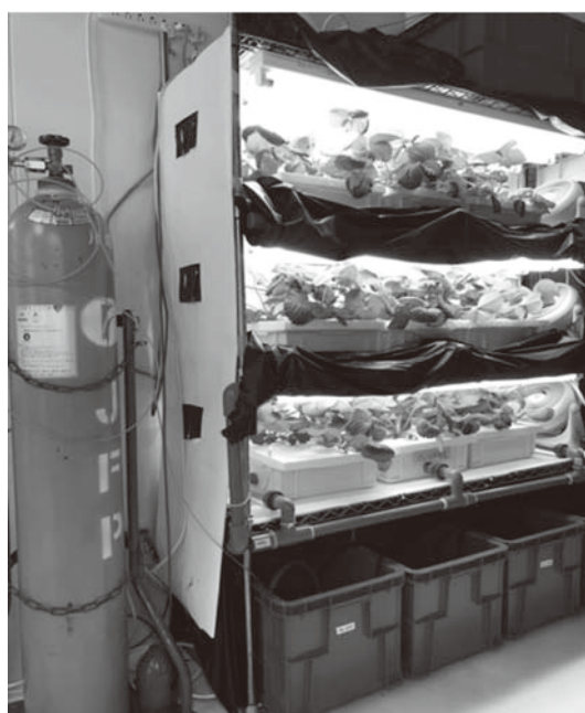
図2 UFB施与栽培装置及びイチゴ栽培の様子
