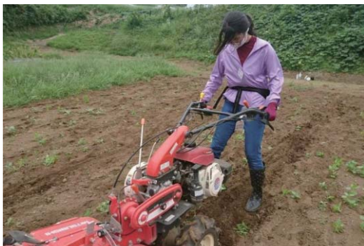
農学部園芸班：小型管理機（マルチャー）を使用したマルチ敷設
