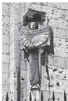
図3 鉛直型日時計。 ヨーロッパに多いタイプで南向きに作られている。(フランス: シャルトル大聖堂)
