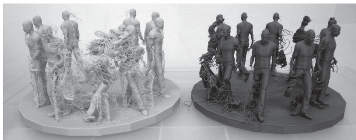
図9. 出力時間：1作品・約12時間（W200×D200×H150mm）
