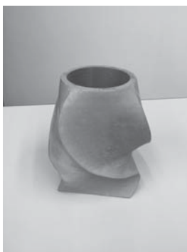
図12. 3Dプリンターによる雄型。これを元にシリコンで雌型を作成した。
