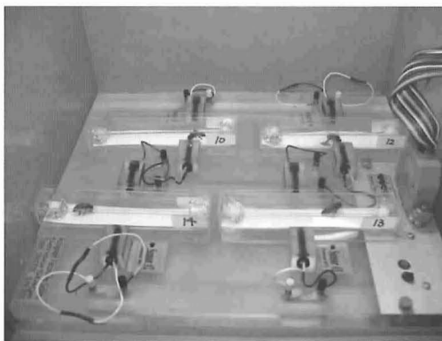
図3 活動リズム解析用の装置であるアクトグラフ (左: 赤外線センサーにより、活動が記録される) とセイヨウミツバチ未交尾および既交尾女王蜂の活動パターン (右: ダブルプロットで示したもの) 縦線はアクトグラフによって活動が検知されたことを表す。未交尾・既交尾女王蜂を 12L:12D の明暗サイクルで 5~6 日維持した後、全暗 (DD) 条件下に移し、活動リズムを測定した。DD での周期的な活動は、概日リズムの存在を示す。Harano et al. (2007) より改変。
