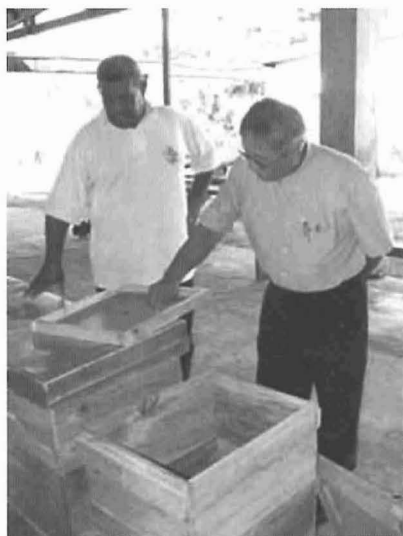
図10 政府の許可を得て無償で伐採できるマツを採って来て、ハンドチェーンソーで板材を作り、町の大工さんが巣箱を作っている。板厚のばらつきは大きく、隙間ができていた。簡易巣箱として単純な形で図面を作って指導したが、あまりにばらつきが大きいので中止した。
