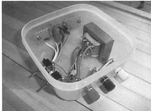
電撃装置本体。他に12Vバッテリー、電気柵、電線等が必要。バッテリーは自動車用を用いた場合、2週間くらいは連続使用が可能となる。
