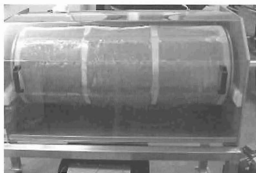
図7 医薬品質ハチミツの濾過。右側からパイプで送り込まれたハチミツは中央の濾過筒に入り、濾過筒の回転に伴って外側に濾し出され、下に落ちる
