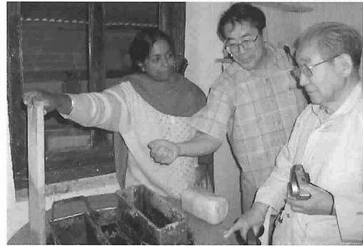
図8 得られた蜂ろうをいったんブロック状にする。これを再度融解して巣礎にも加工できる
