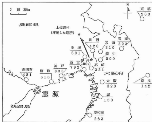
図3 阪神・淡路大震災による水平方向の地面の揺れの強さ (単位ガル)
